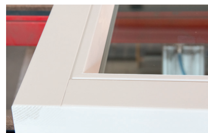
Afdichten van isolatieglas
