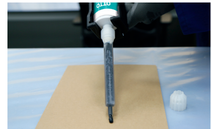
Uittreden rups en homogeniteit van het mengsel controleren (zie verwerking begeleidende kwaliteitscontroles 2K-producten)
