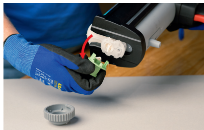
Wartelmoer afschroeven en stop verwijderen
