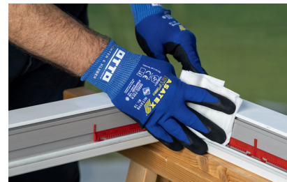
Voorbehandeling van het te lijmen oppervlak van het profiel met OTTO Cleanprimer (dan wel cleaner + primer) 1)
