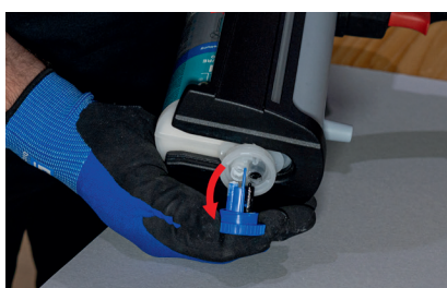
Stop afschroeven en verwijderen
