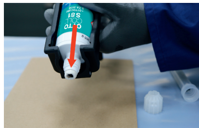
Materiaal zonder statische menger uitdrukken, totdat er bij beide openingen materiaal uittreedt
