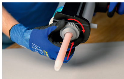
Statische menger met de wartelmoer fixeren
