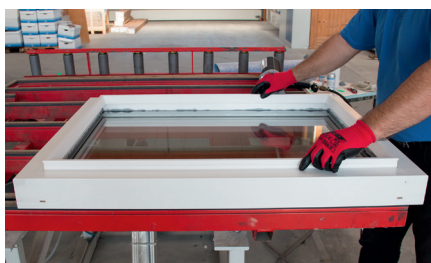
Inleggen van de glaslatten
